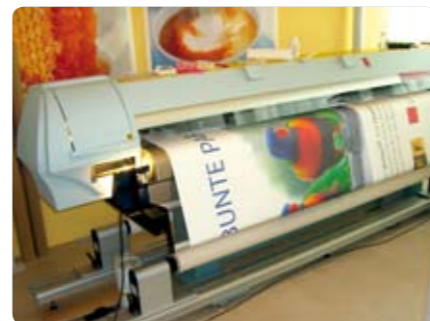
Druckmaschine, Druckbreite 220cm
